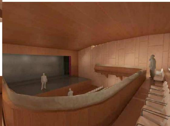
La acústica ha sido la configuradora del propio espacio. El techo es un elemento fundamental de configuración acústica del espacio. Será un elemento activo dependiendo de la actividad que albergue nos ayudará a optimizar la calidad acústica. El techo se conformará en cuatro superficies móviles ajustables en inclinación y una fija en madera como el resto de la sala.
